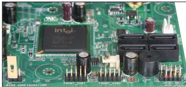
Figura 19. Podemos observar los conectores para el panel frontal del motherboard: los dos de la izquierda corresponden a puertos USB, el de la derecha a los comandos externos del gabinete ( Power y Reset , entre otros).
