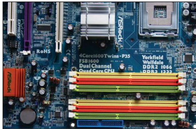
Figura 14. Podemos apreciar la convivencia de dos tecnologías de zócalos en un mismo motherboard. La DDR 2 (ranura amarilla y roja) y la DDR 3 (ranura verde). Observemos también la separación de los tabiques entre todas las ranuras.
