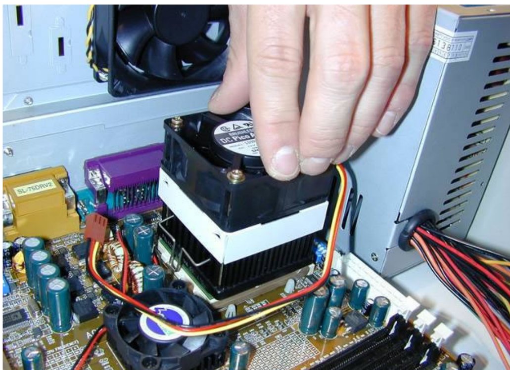
... posiciono el disipador de la CPU...
