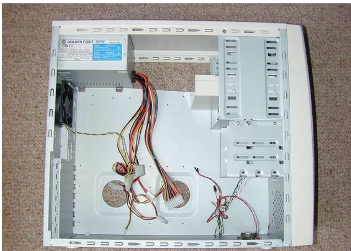
La fuente de tensión de 300W (puede ser mayor, lo cual permitirá conectar más dispositivos) y un ventilador adicional de la gabinete, llamado también Fan Case.
