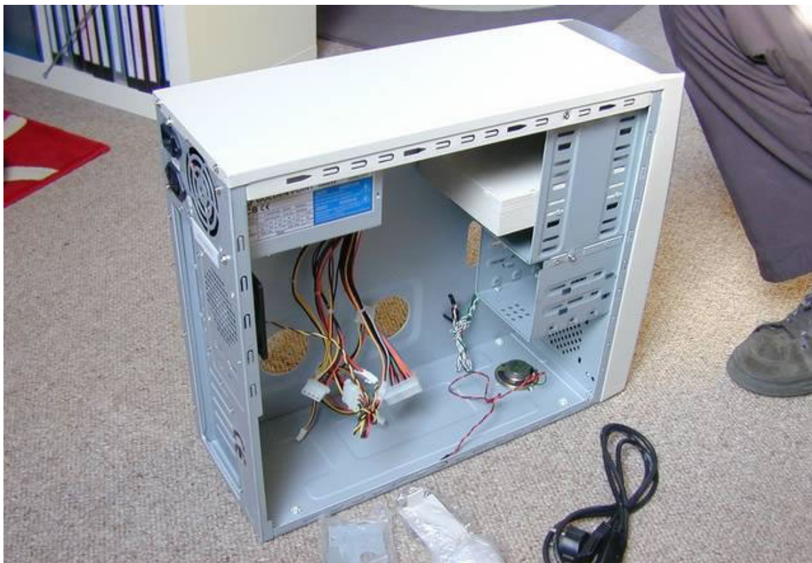
Los cables de interruptores, LED's, altavoz, bolsas de tornillos, postes, etc. ...
