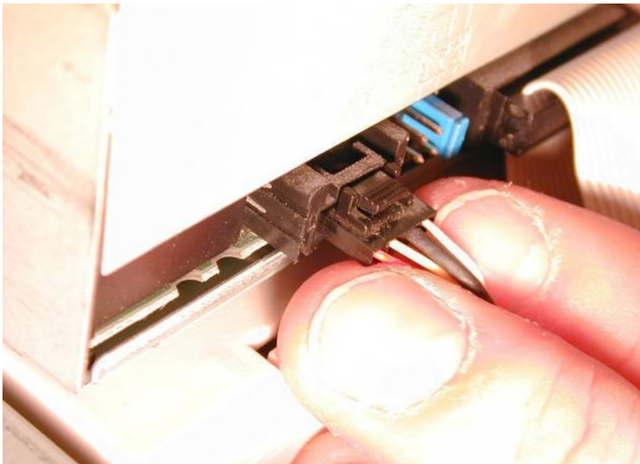
Foto de conexión del cable de audio en la placa Madre.
