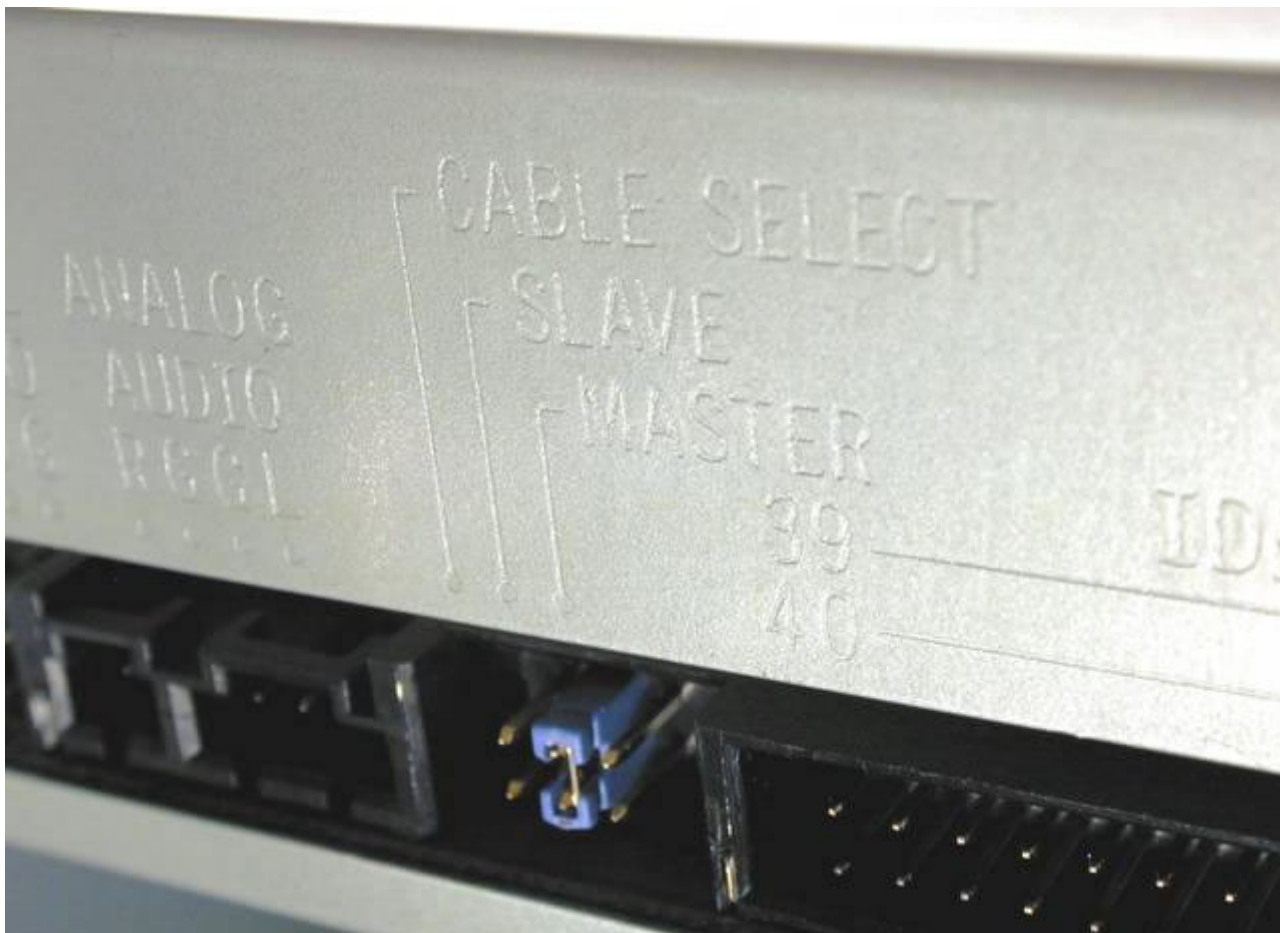
Foto del Jumpere de la grabadora de CD en maestro o master (derecha de los tres pares de pines).
