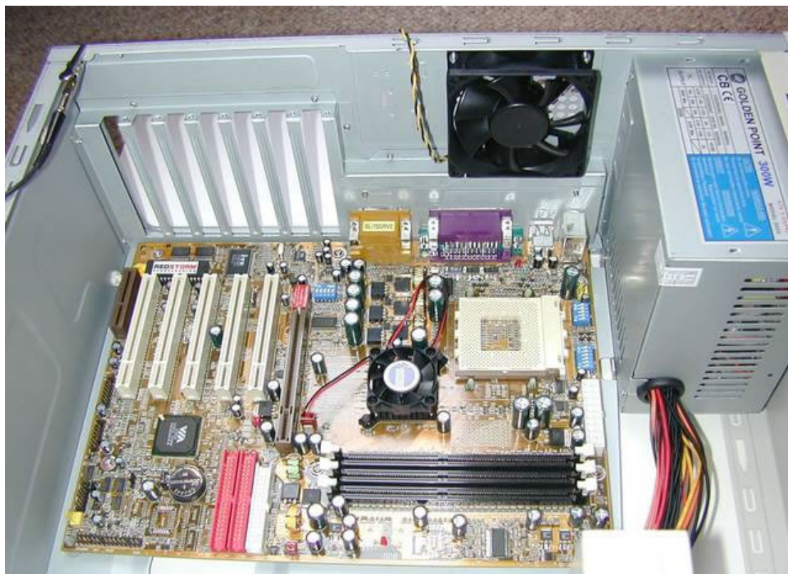
Foto del montaje mecánico del Motherboard sobre el gabinete ATX acabado.
