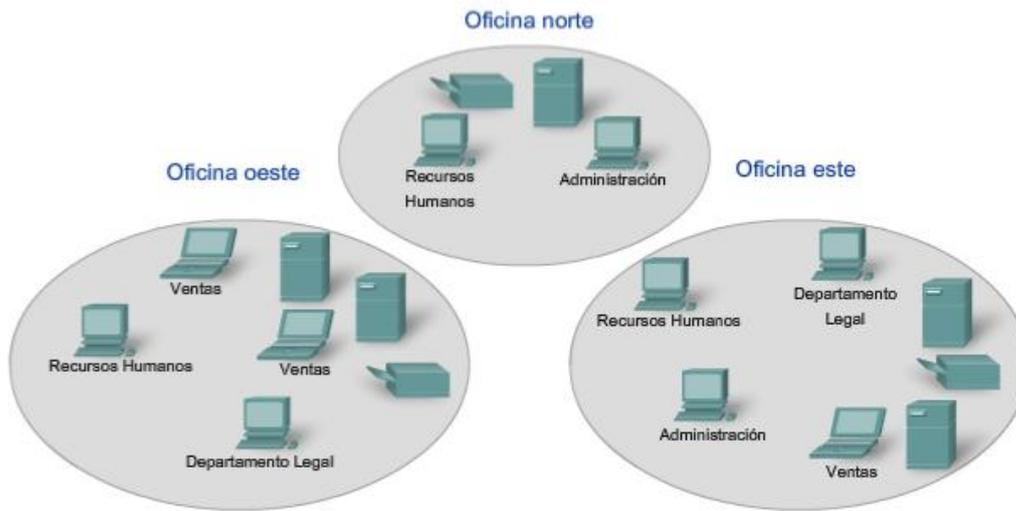
El simple hecho de conectar por cables la red física puede convertir la ubicación geográfica en un lugar lógico para realizar el inicio de la segmentación de una red.
