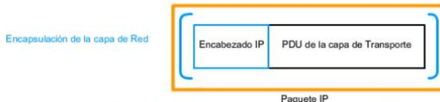
En **redes basadas en TCP/IP**, la PDU de la capa de Red es el **paquete IP**.
