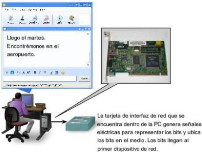
La tarjeta de interfaz de red que se encuentra dentro de la PC genera señales eléctricas para representar los bits y ubica los bits en el medio. Los bits llegan al primer dispositivo de red.
